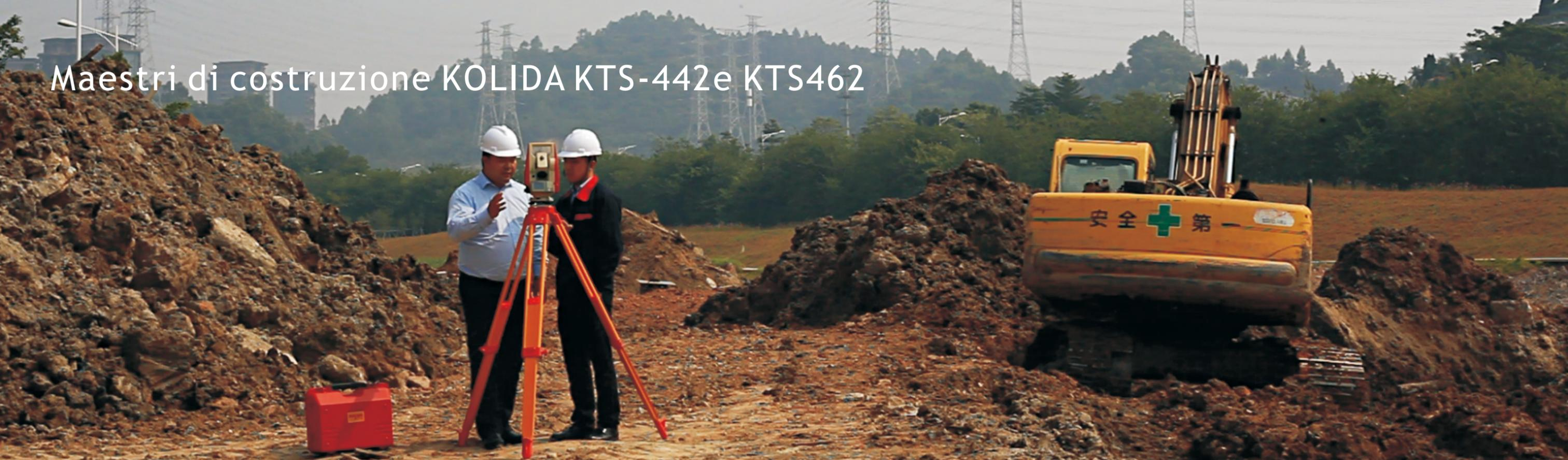
**Fino a 2000 m senza riflettore / 5 km con prisma / Precisione angolare 2 "/ Compensazione a doppio asse /
